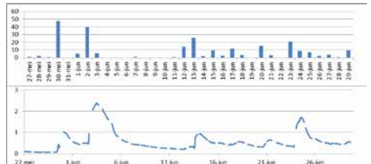
Figuur 3.8: Afvoer Oeffeltse Raam. (kuub per seconde) met neerslag (millimeter per dag). Meetlocatie: in de duiker onder de A77.
