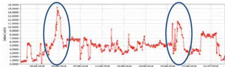
Figuur 3.20: verhoogde afvoeren via de Schabbert tijdens pieksituaties
