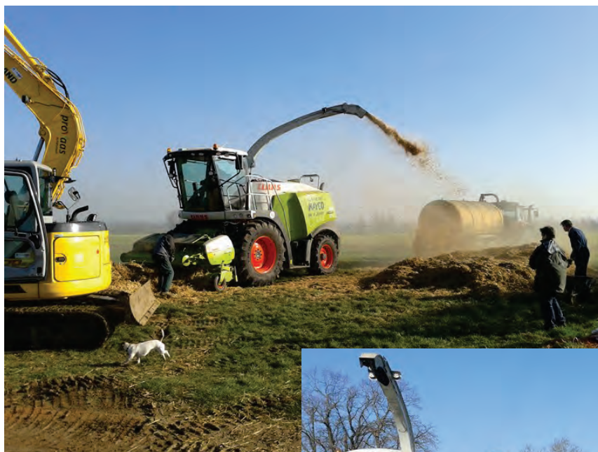
Afbeelding 9: Hakselen van het stro met een zelfrijdende hakselaar
