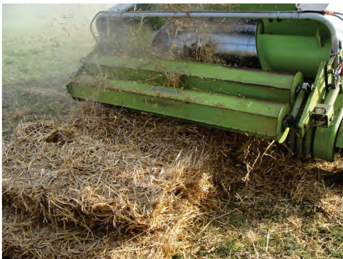
Afbeelding 1: Hakselen van het tarwestro met een zelfrijdende hakselaar.
