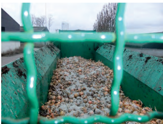
Afbeelding 4: Mengen van reststromen en Bokashi-ingrediënten in mestverspreider
