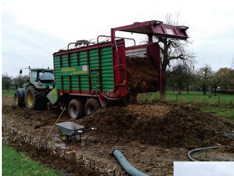
Afbeelding 6: Aanbrengen van een laag korrelmaïsstro met behulp van een dubbeldeurwagen.
