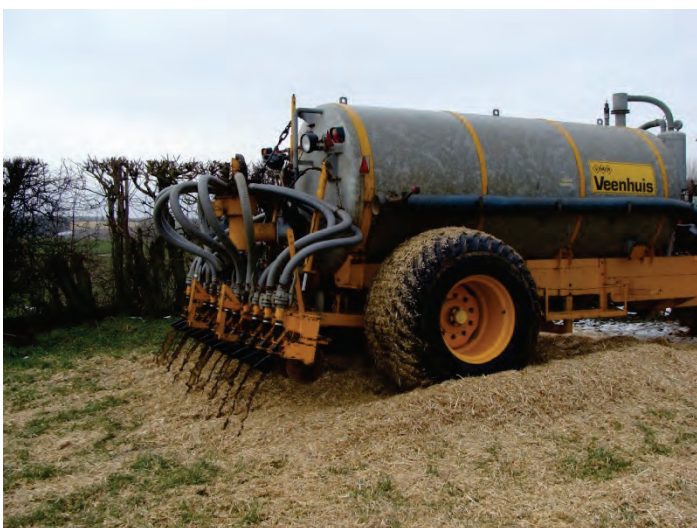
Afbeelding 2: Aanwenden van varkensdrijfmest met een zodebemester over het tarwestro.
